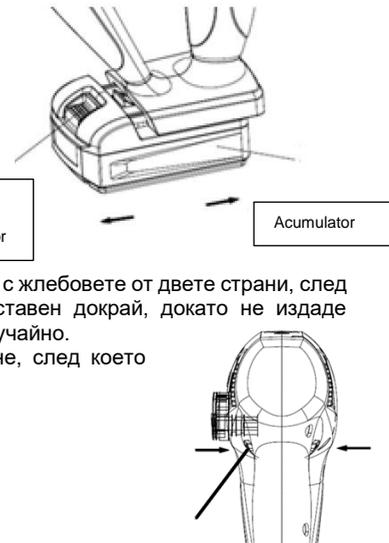
Винаги проверявайте посоката на въртене преди работа. Използвайте превключвателя за заден ход само след като инструментът е спрял напълно. Натиснете превключвателя за посока от дясно на ляво или обратно в зависимост от желаната посока на въртене. Промяната на посоката на въртене преди спиране на инструмента може да го повреди. Когато не използвате машината, винаги поставяйте лоста за превключване на заден ход в неутрално положение. Преди употреба проверете зададената посока на въртене.
